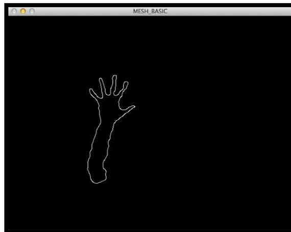
Figure 22: Canny Edge Detection.
